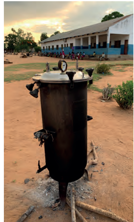
▲ Unter dem defekten Sterilisateur liegen noch die verkohlten Holzreste, mit denen das Personal versuchte, das Wasser im Gerät behelfsmässig zu erhitzen. bg
