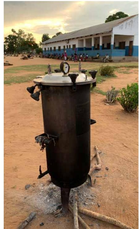
▲ Unter dem defekten Sterilisator liegen noch die verkohlten Holzreste, mit denen das Personal versuchte, das Wasser im Gerät behelfsmässig zu erhitzen. *bg*
